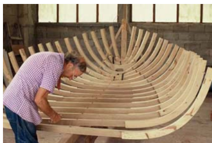
Protomeštar Bakica namješta rebra gajete na njezinu kobilicu
