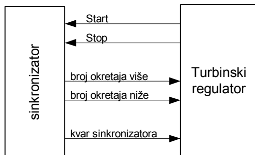
Slika 4: Povezivanje sinkronizatora i turbinskog regulatora
